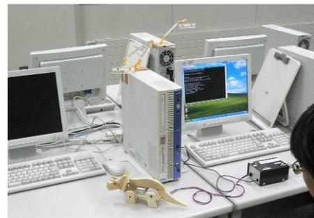
図1 パソコンからマイコンへプログラムをロードし恐竜ロボットを制御している
