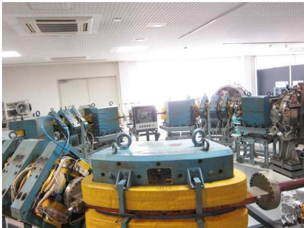
SOR-Ringと呼ばれる実際に使用していた実物の電子蓄積リング。これを見ながら電子の加速と放射光取り出しの原理について解説していただいた。
