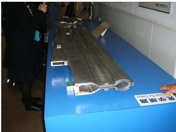
電子蓄積リングに実際に使用されている真空チャンバーのサンプル。超高真空中をした中を光速に近い電子が走っていくという。
