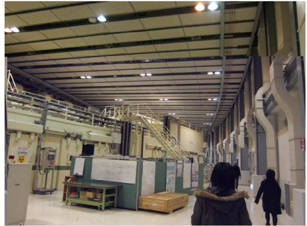
蓄積リング棟の内部。X線放射光は蓄積リングの接線方向に放射されるので、これを捉えるて利用する実験ステーションも同様に設置されている。
